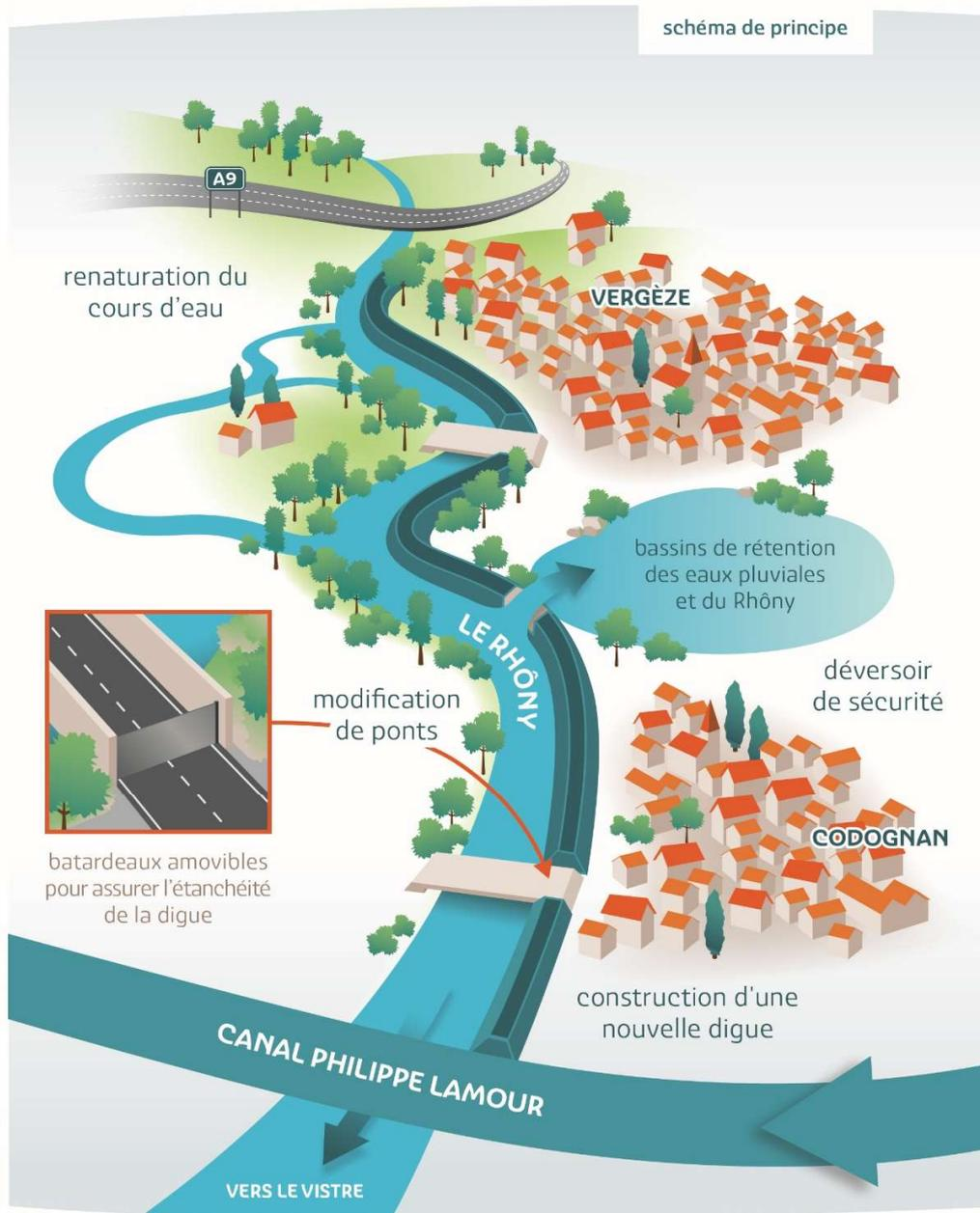
Figure 36 : Infographie de l'opération de renforcement des digues du Rhône à Vergèze et Codognan
